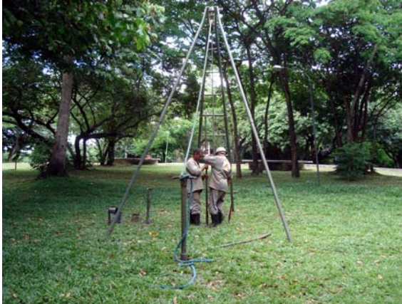
Ilustração 2 - Equipamento utilizado para a realização de sondagem.
